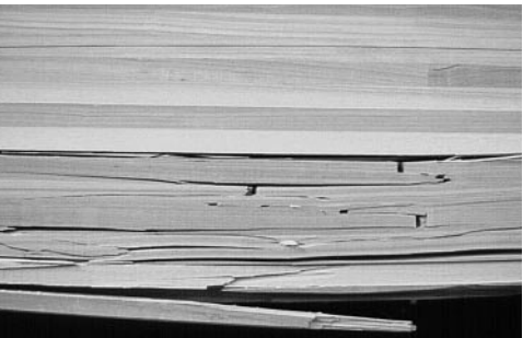
Mit einer durchschnittlichen Biegefestigkeit von knapp 50 N/mm 2 lieferten die Träger aus Pappel überraschend gute Werte
